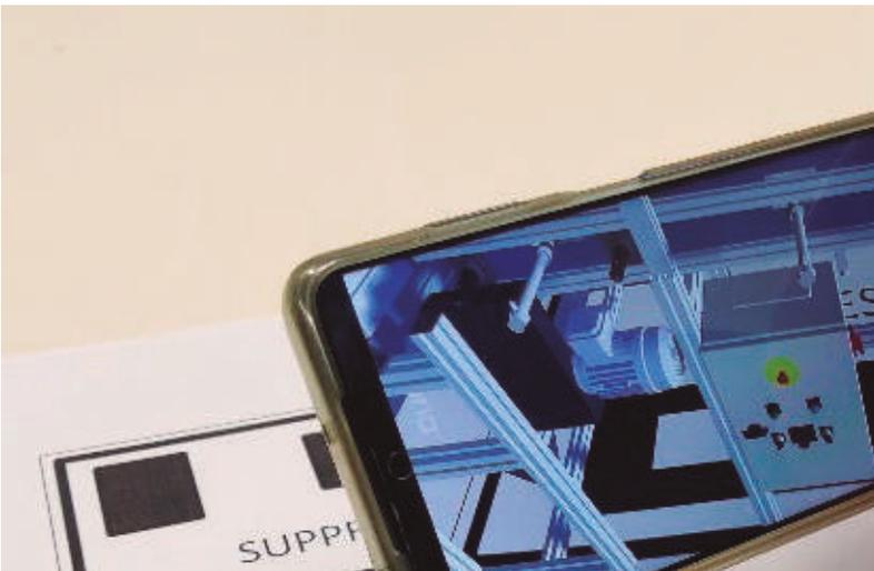
Figura 9-3. Uso de la aplicación de realidad aumentada para visualizar los elementos de la célula electroneumática
